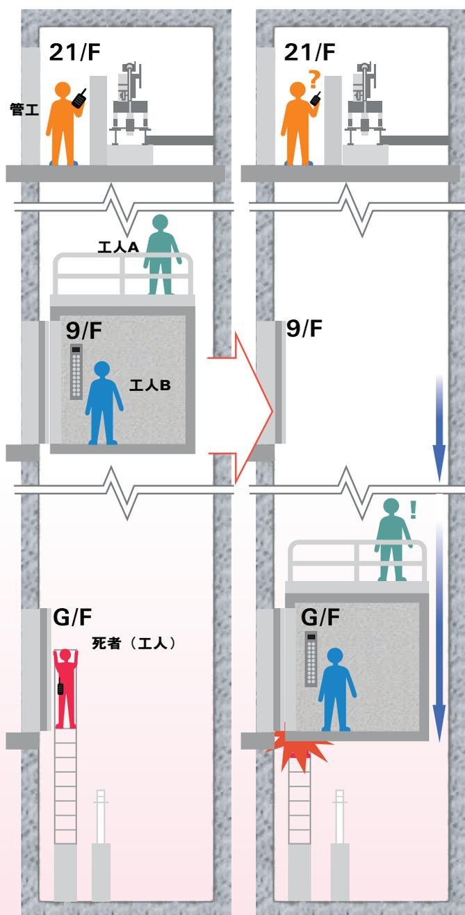
意外發生時，另外兩名工人的其中一人，在升降機機廂頂以手動模式操作升降機。當升降機機廂下行並接近地下時，死者被壓倒並夾於升降機機廂與金屬梯子之間。
